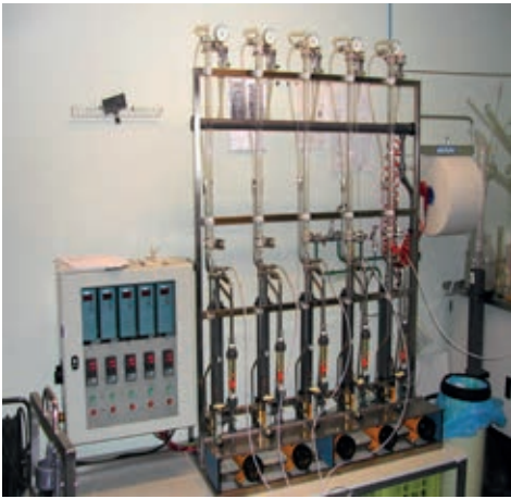
Figuur 3 De Pentamonitor met doseermogelijkheid voor desinfectiemiddelen.
